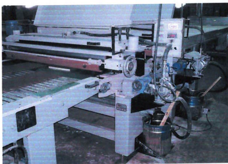
foto 31 – detalhe da máquina que aplica verniz e da lata de verniz aberta no lado esquerdo e abaixo
