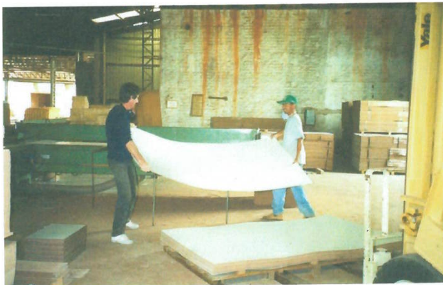
foto3 – detalhe do posicionamento das placas de MDF para o corte
