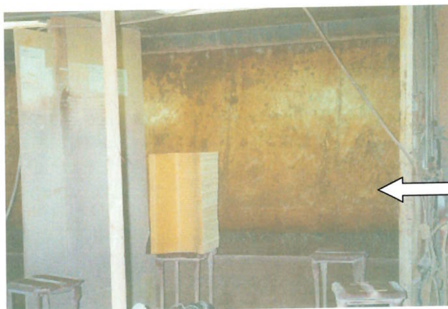
foto 10 – detalhe da cortina d'água e da peça cortada e já pintada
