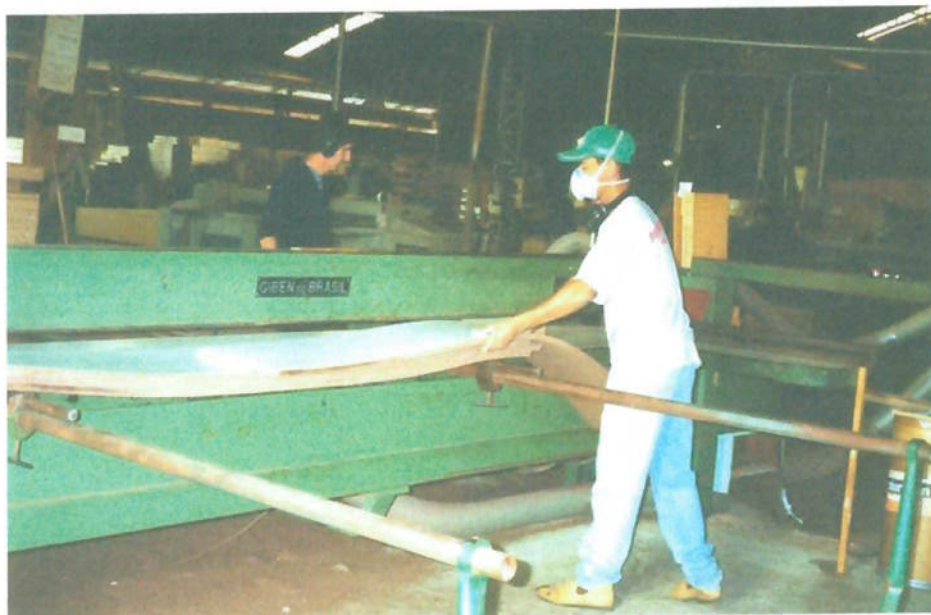
foto 4 – detalhe do processo de corte da placa de MDF
